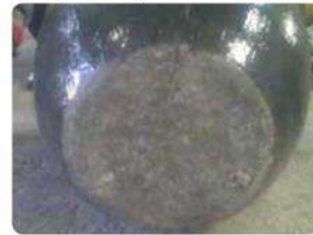
Рисунок 20. Термическое напряжение, вызванное слишком быстрым нагревом тигля
