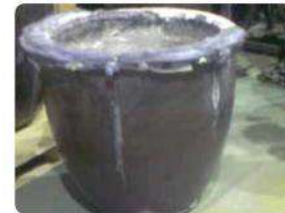
Рисунок 22. Образование окислы на верхней кромке тигля.
