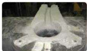
Рисунок 8. Законченная верхняя крышка.
