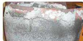
Рисунок 5. Окисление верхнего края, вызванное нависанием керамического одеяла.
