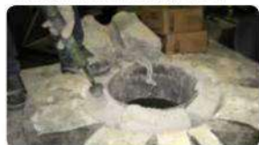
Рисунок 8. Пневматическая трамбовка материала верхней крышки.
