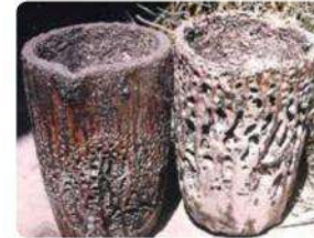
Рисунок 21. Распространение флюса, вызванное повышением количества флюса и неправильной очисткой.
