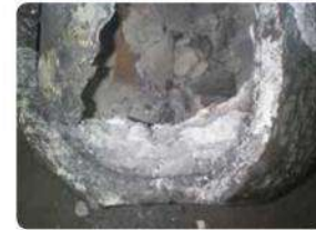
Рисунок 23. Образование окислы на дне тигля.
