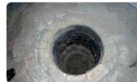
Рисунок 12. Угольная печь, готовая к установке тиглей.
