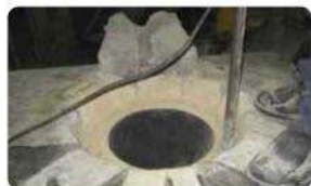
Рисунок 6. Трамбовка 50-75мм подкладочного материала вокруг тигля.
